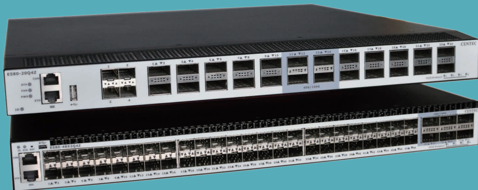
V580-20Q4Z 20ポート(40G)QSFP+, 4ポート(100G)zQSFP+
